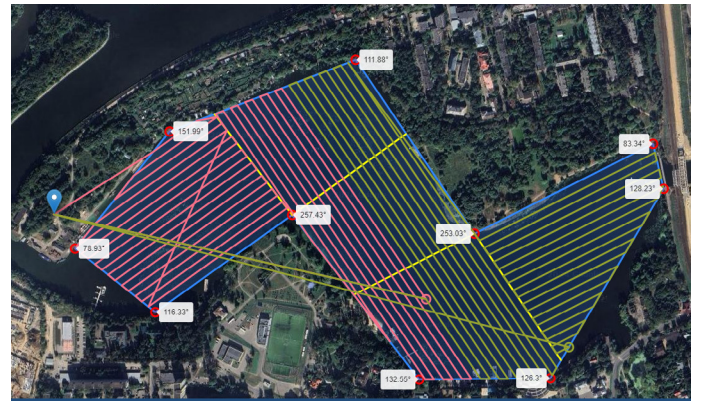
Рис. 3. Пример формирования маршрута для двух БПЛА
