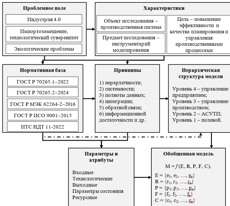
Рис. 1. Концептуальный каркас моделирования алюминиевого производства
