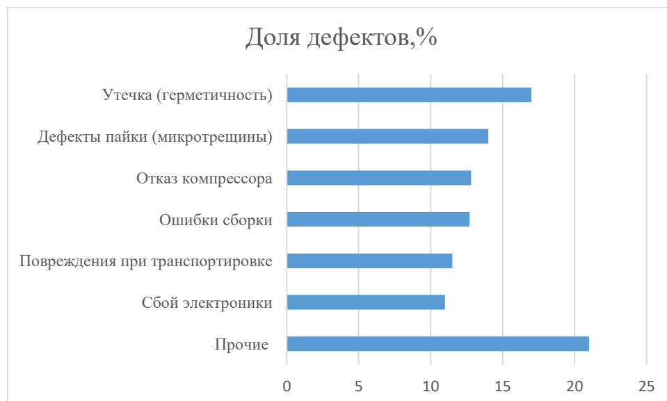
Рис. 2. Структура дефектов промышленного производства бытовой техники по ретроспективному анализу за 5 лет
