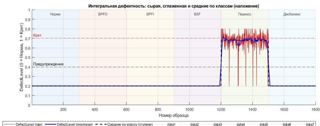
Рис. 8. Интегральная оценка дефектности DefectLevel по образцам датасета
