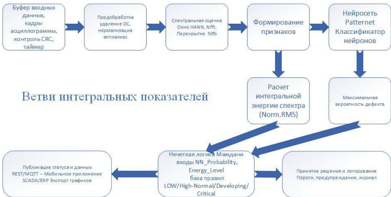
Рис. 2. Конвейер обработки и принятия решения на узле Raspberry
