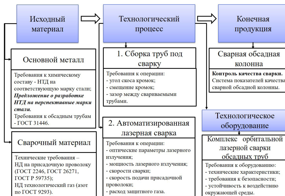
Рис. 3. Схема технологии лазерной сварки обсадной колонны
